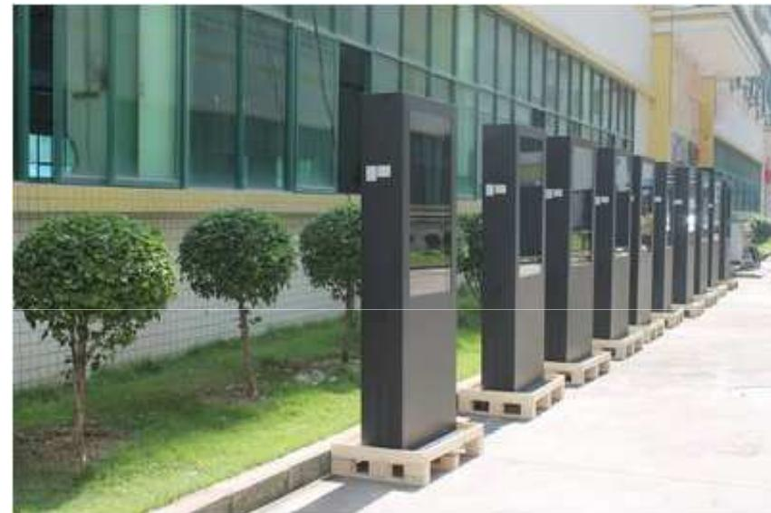
Simulação e teste de radiação solar
