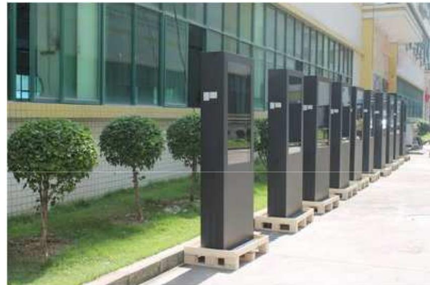
Simulação e teste de radiação solar
